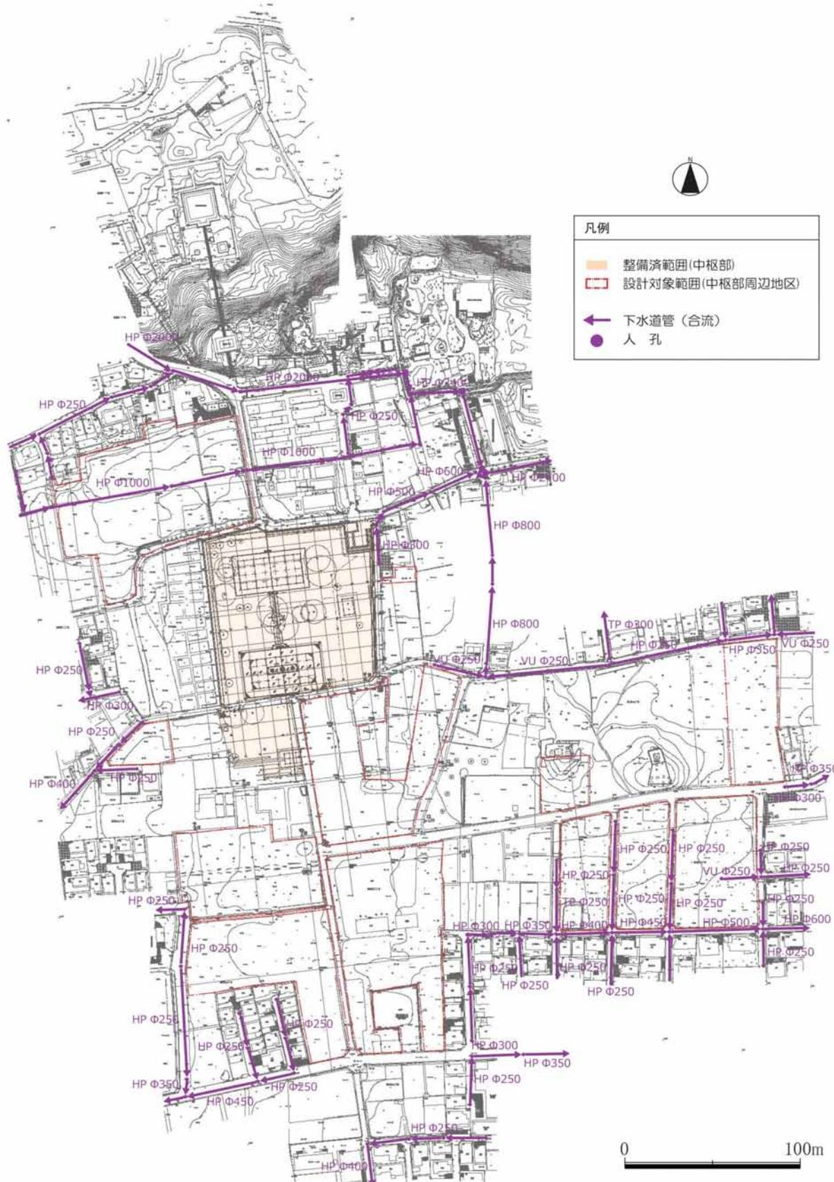
図 12 下水道設置状況図
