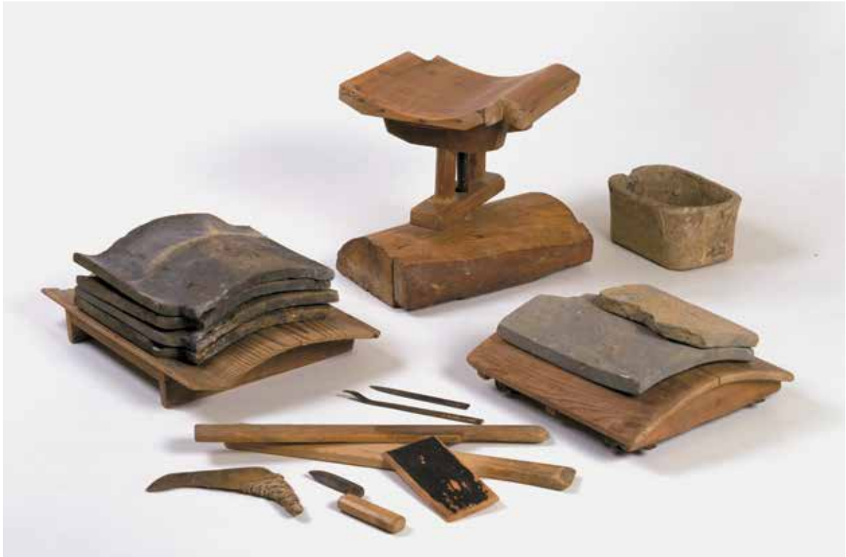
戦前の造瓦器具と出土瓦 右は金閣寺出土、左は近世の瓦。(造瓦器具は京都府立山城郷土資料館蔵)
