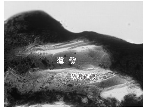
Fig.54 C部分拡大 (道管と放射組織に浸透する漆)
