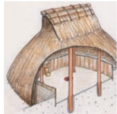
図1 竪穴住居の構造
