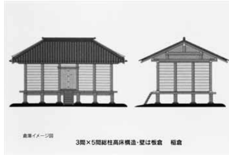
図14 3×5間総柱高床構造
