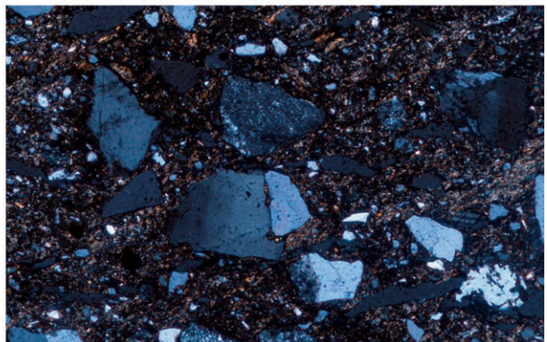
8. 試料No.29 宮ノ前遺跡 SH12 S字状口縁台付甕(A類) 鈴鹿川流域、比較試料 Qz:石英, Kf:カリ長石, PI:斜長石, Che:チャート, P-Qz:多結晶石英, Gra:花崗岩. Vg:火山ガラス, P:孔隙. 写真左列は下方ポーラー、写真右列は直交ポーラー下。
