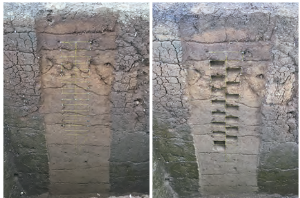
テストピット 分析用試料土壌採取状況
