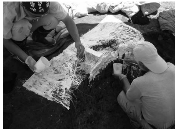
写真8 内型(シリコン樹脂製)製作
