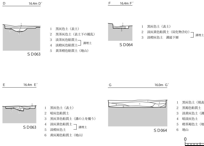
第35図 SD 063・064 土層実測図 (1/60)
