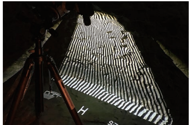
写真 28 非接触光学式 3 次元計測器 格子投影
