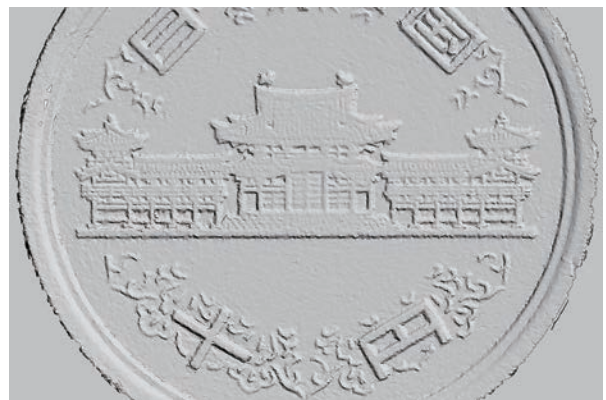
図 164 SfM による 10 円玉表面の形状データ
