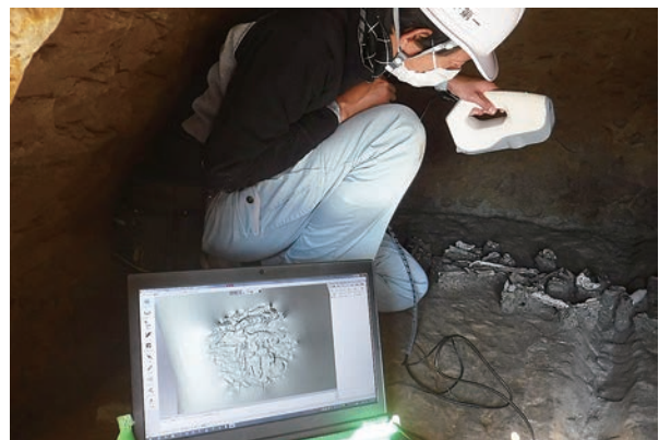
写真 29 ハンディースキャナ 計測状況
