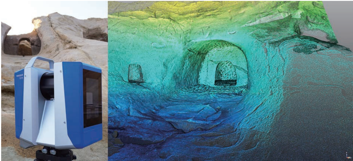
写真 30 左) 地上型レーザー計測器・右) 計測状況及び取得点群データ段彩表示
