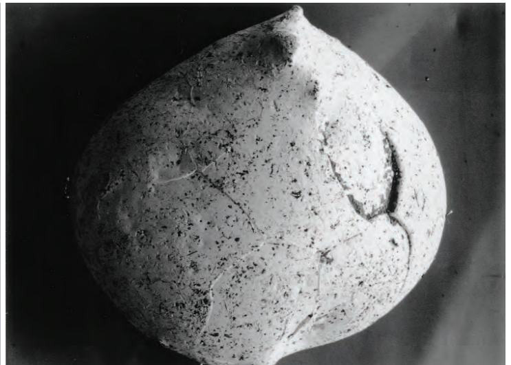
C-4-2 熔滴の表面（電子顕微鏡観察）
