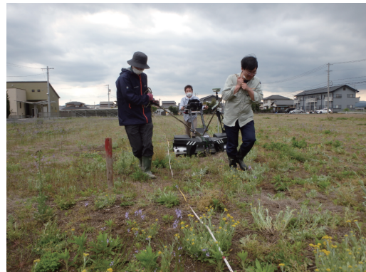
地中レーダー探査の実施状況
