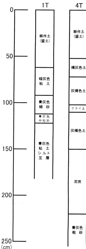
第14図 万年地区土層柱状図(S=1/20)
