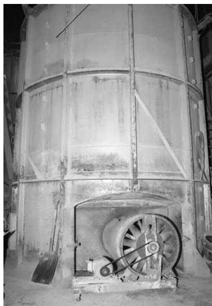
左-15 焼成炉外観 ロストルに送風機が取り付けられている様子。
