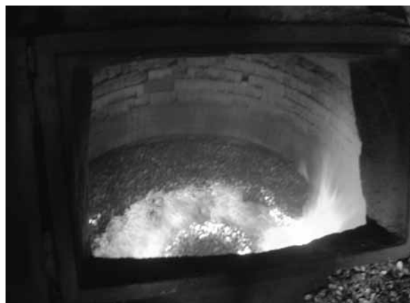
左-16 焼成炉内部 貝殻とコークスが焼成されている様子。
