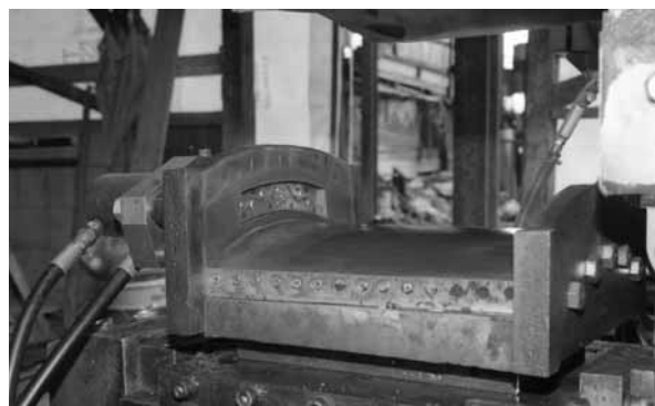
写真：屋-2 軒平瓦プレス機
