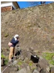
写真-1 障害物がある場所での計測の様子
