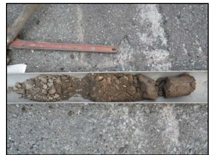
(8) ボーリングコア
