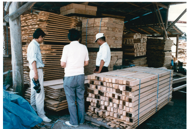
図 4-31 木工事 木材検査 (寄材他)
