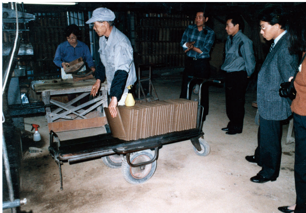
図 4-52 屋根工事 屋根瓦製作検査
