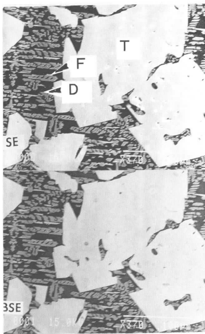
図6 A3号No.2鉄滓のEMPAによる2次電子像と反射電子像、定性分析
