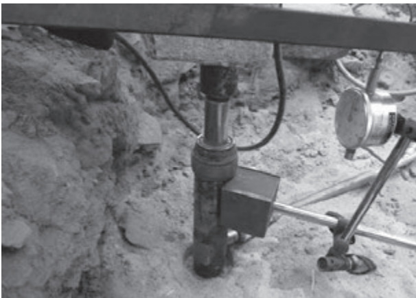
写真-9 載荷試験載荷版周辺での散水
