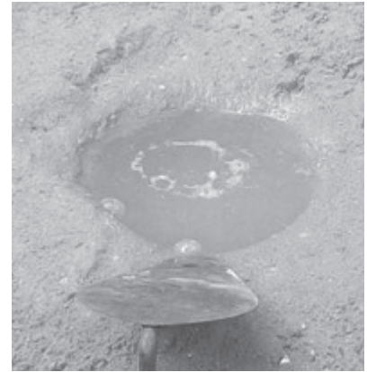
写真-24 裸孔の給水と形状保持
