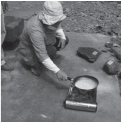
写真-13 混合土の含水比計量
