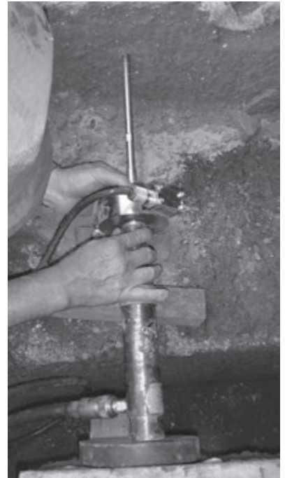
写真-27 養生後側壁部分の強度検査
