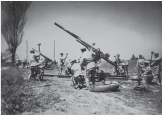
地面に杭を打って野戦用高射砲を設置
