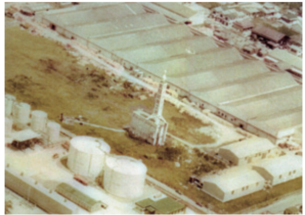
航空写真 1974年 屋上に大日繊維工業の広告塔が立つ。 クレーンを用いない起重機の形式で、袖壁は地上まで達していたことがわかる。 左図共 ハリマ化成所蔵
