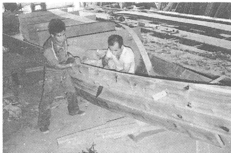
舟の横板の摺り合せ (砂賀造船所)
