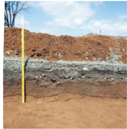
写真92 2 T 土層断面
