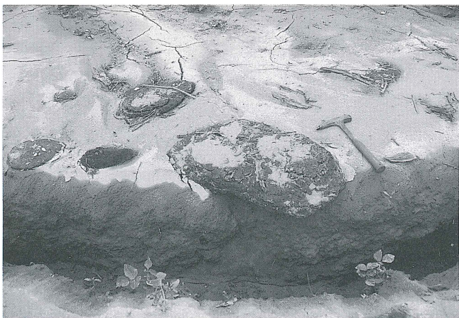
第15図 “ピートボール”の噴出（字豊田）
