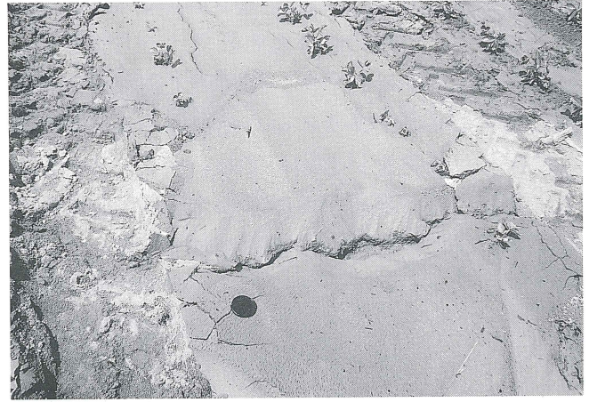
第11図 噴砂のタイプ 2) 割れ目噴火型 (字神丘)
