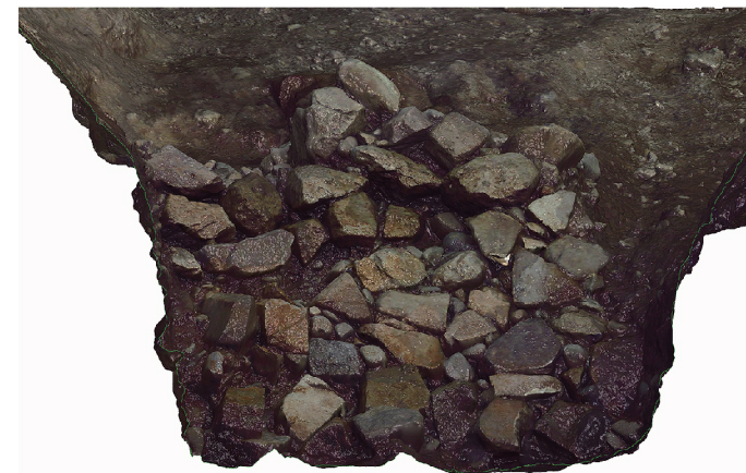
図4 3次元測量点群図 石垣立面 (S=1:50)
