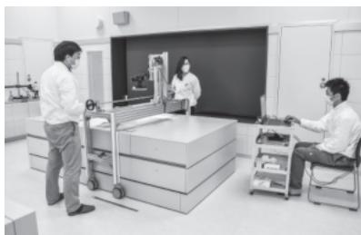
キトラ古墳壁画南壁のモニタリングのためのSfM/MVSによる撮影
