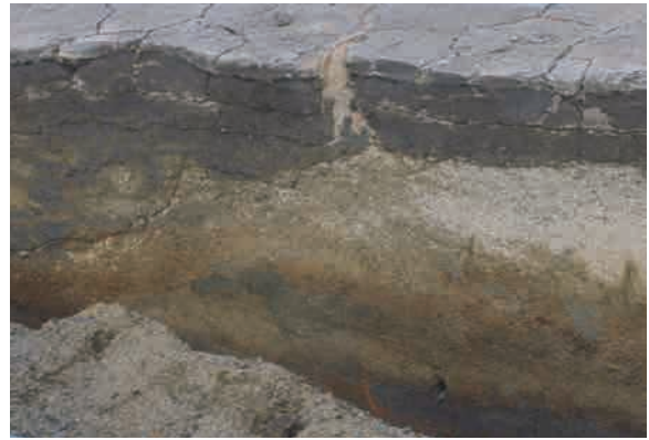
写真7-7 液状化した地層と砂脈（地点4）
