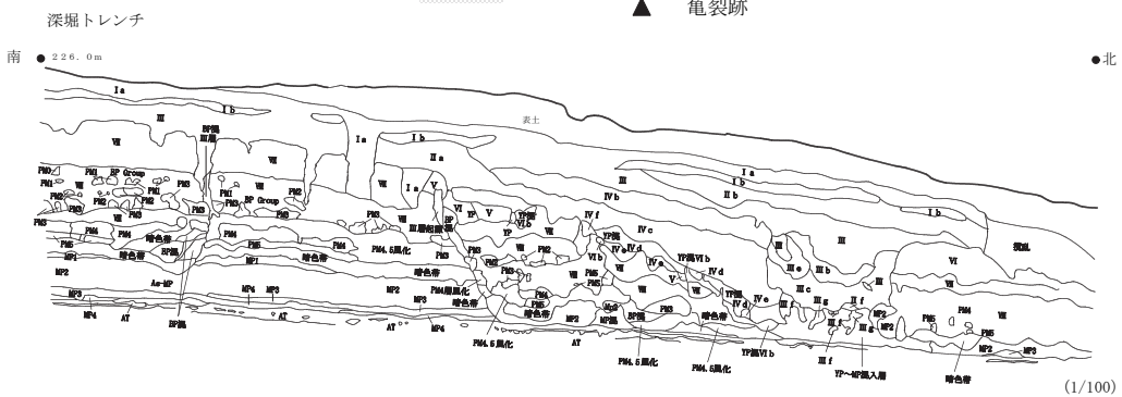
第5図 蔵畑Ⅱ遺跡周辺における断層の位置と断層断面図
