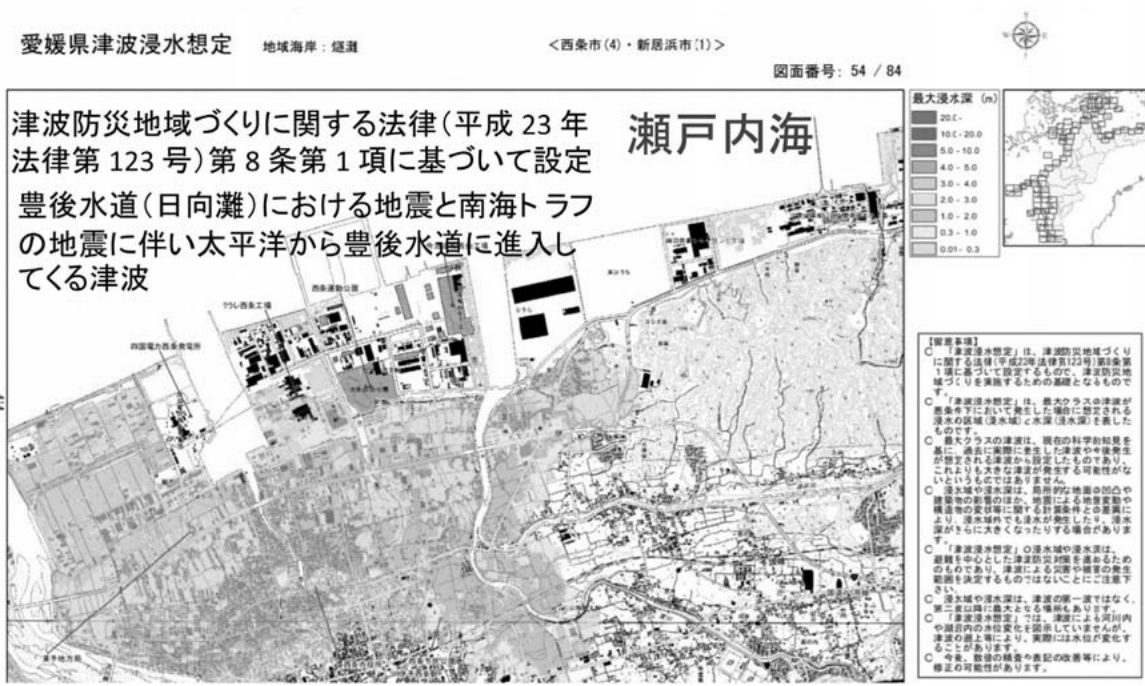
図8 愛媛県地震被害想定—瀬戸内海側の浸水(西条市)
