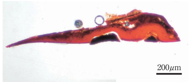
図11-2 P98-4-aの塗膜状破片断面
