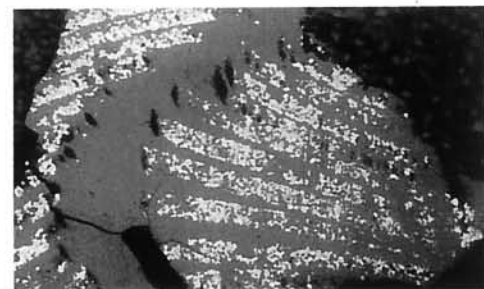
沈金加飾のある漆塗膜面の表面拡大写真 (×100)
