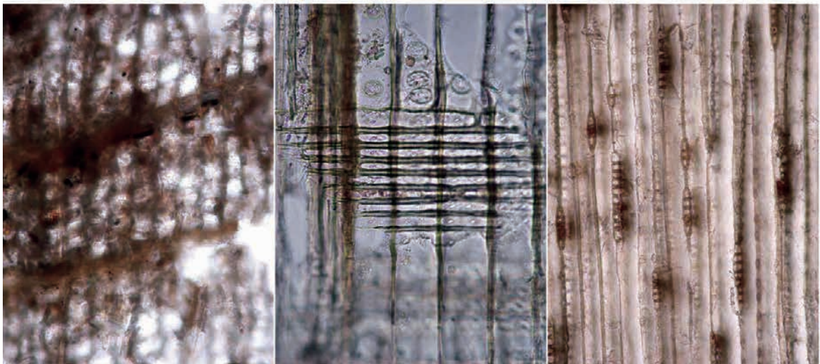
横断面 0.1mm 放射断面 0.1mm 接線断面 0.1mm 樹種No.128 サワラ へら
