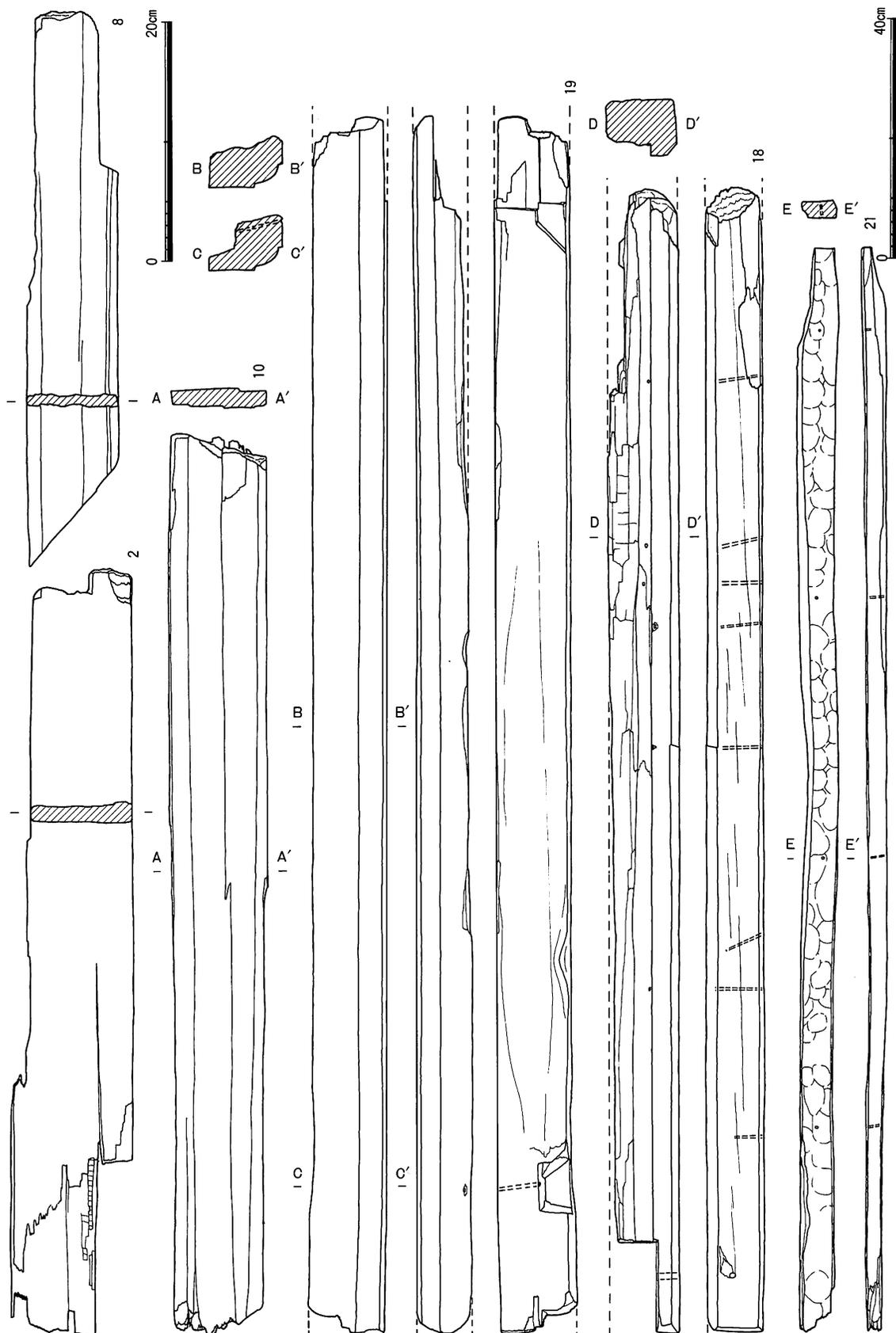
建築部材実測図 屋根板(2.8)・野地板(10)・回り縁(18)・幣軸(19)・床板(21)
