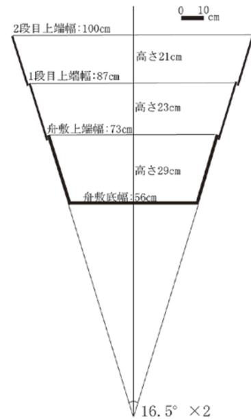
図4 舟敷長7m位の板綴船推定横断面
