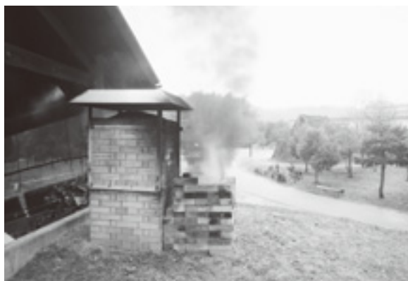
写真3 排煙口からの黒煙・炎（開始72時間後）
