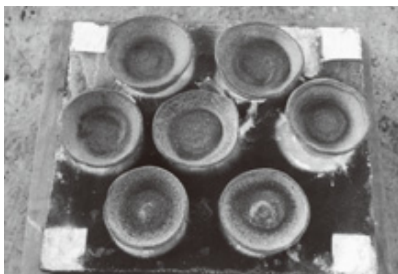
写真7 焼成作品の黒粒状降灰の融着状況（H3棚）
