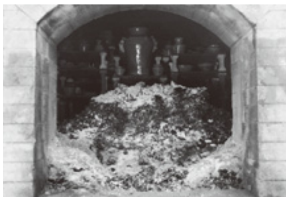
写真5 窯出し直前のオキの蓄積状況
