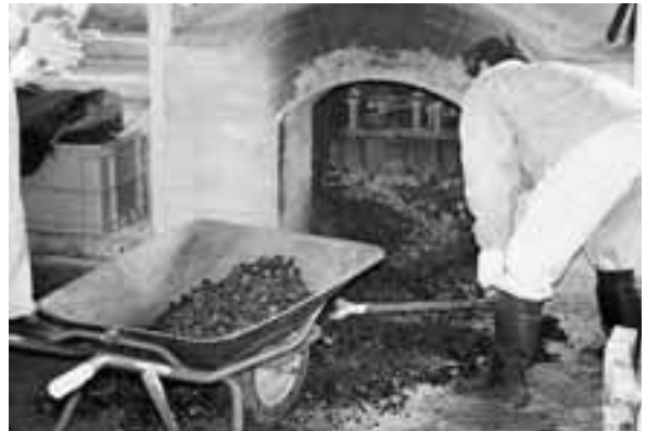
写真13 窯出し時のオキの状況
