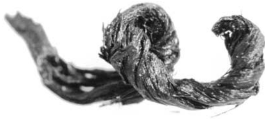
写真18 太い糸から派生した糸が捻じられてループ状を呈した部分(6-66)
