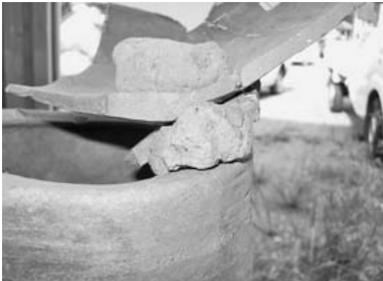
写真11 粘土トチンと匣鉢の取り付け具合
