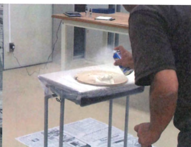
⑧塗料による塗装
