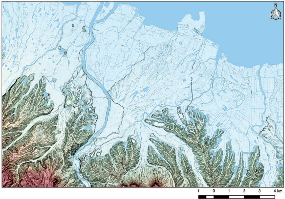
図4 八面山から山国川、犬丸川流域のDEMによる段彩図、傾斜強度図に水系分布を重ね合わせた図
