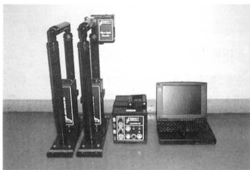
Fig.111 地中レーダーの測定装置
