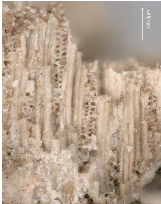
図6 ①合金付着木材（2細胞幅の放射組織が並ぶ）
