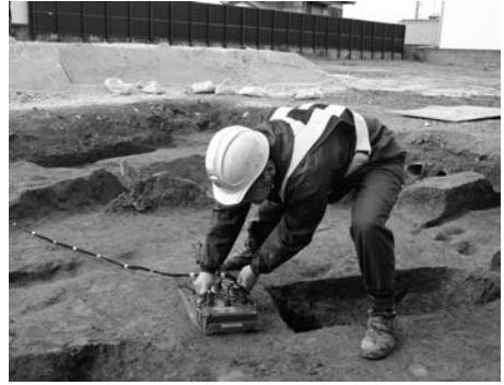
1 地中レーダー探査
