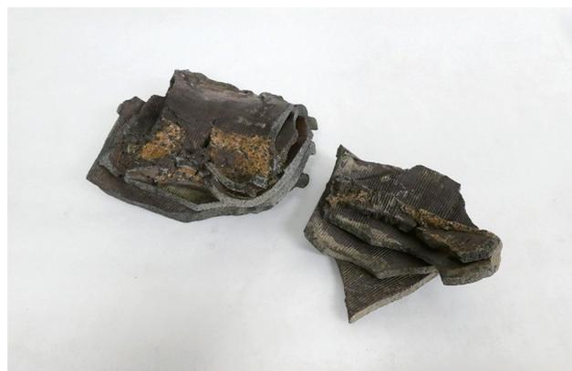
図36 焼成不良品（本焼き挿鉢：接合確認）
