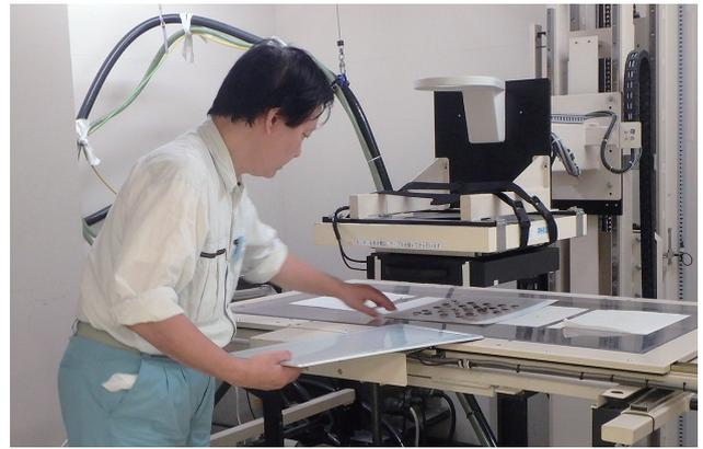
図 25 金属製品の X 線透過撮影
