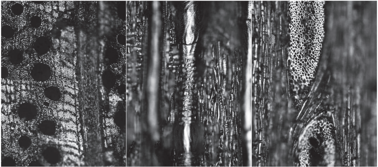
横断面 0.1mm 放射断面 0.1mm 接線断面 0.1mm 試料2. コナラ属アカガシ亜属 SC1
