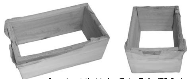
ブロックの木枠(内寸：幅11×長19×深7.5cm)
