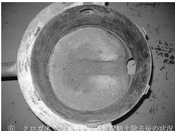
⑥ クロガネくん1号炉炉底敷設粘土除去後の状況
