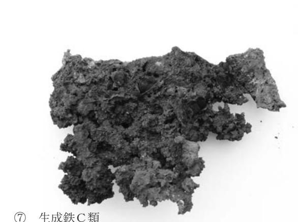
写真9 3号炉小割り作業と生成鉄
