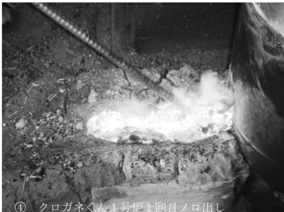
④ クロガネくん1号炉1回目ノロ出し
