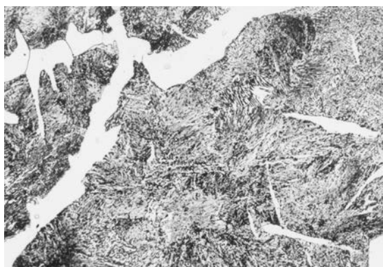
写真 65 資料 No. 2 塊状の金属鉄部分顕微鏡写真 × 100
