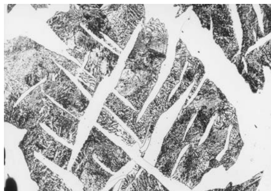
写真 62 資料 No. 2 塊状の金属鉄部分顕微鏡写真 × 100
