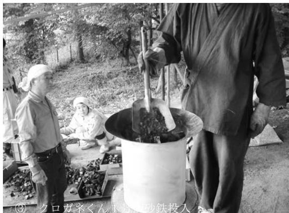
③ クロガネくん1号炉砂鉄投入
