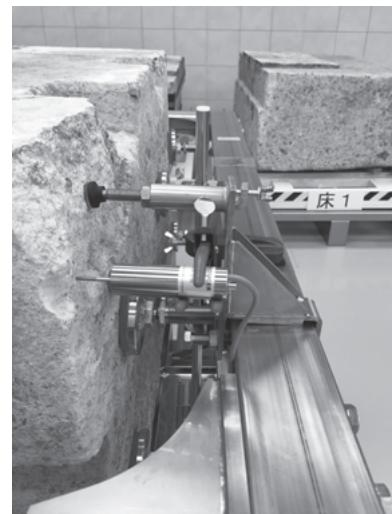
高松塚石室石材の振動に対する安定性調査。センサー設置状況。
