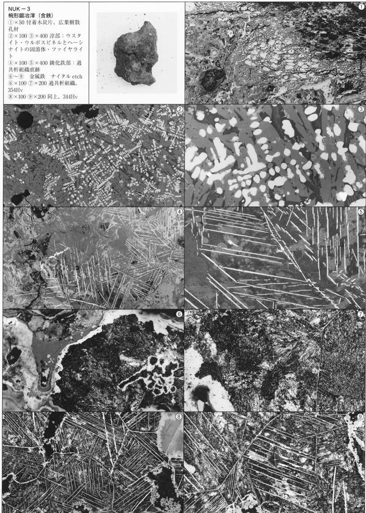
Photo.2 梘形鍛冶滓 (含鉄) の顕微鏡組織
