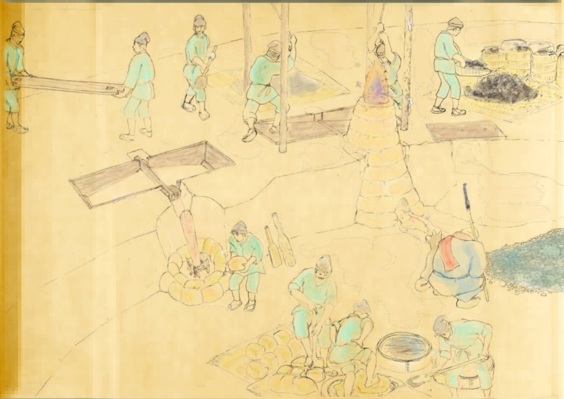
国指定史跡「横大道製鉄遺跡」8世紀中葉頃の豎形炉操業推定図
