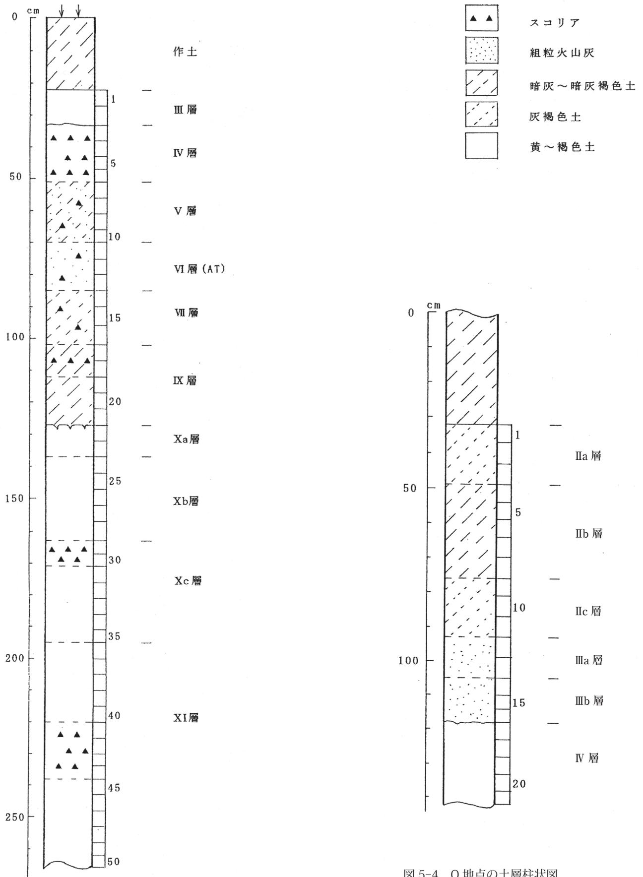
図 5-3 M 地点深掘トレンチの土層柱状図
