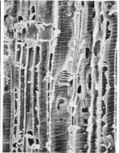
2c 広葉樹A (放射断面) 5D T69 bar:0.1mm
