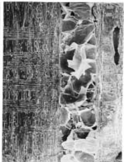
7c クスギ節 (放射断面) 11D T17 bar:1.0mm
