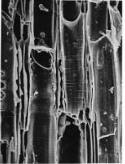
16c トチノキ (放射断面) 22D T47 bar:0.1mm
