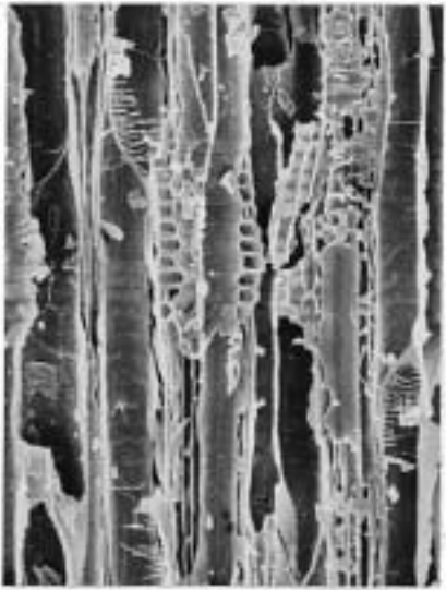
4c ハンノキ亜属 (放射断面) 11D T152 bar:0.1mm
