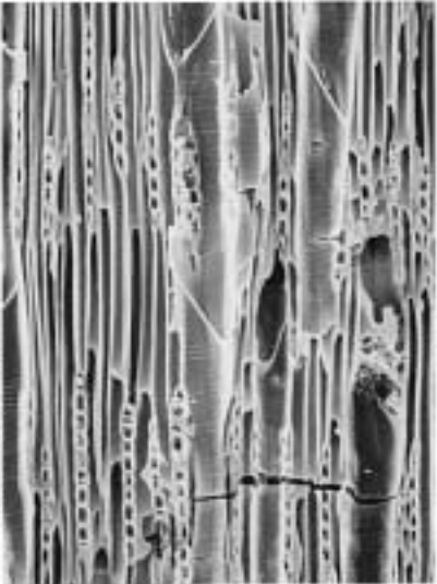
16b トチノキ (接線断面) 22D T47 bar:0.1mm
