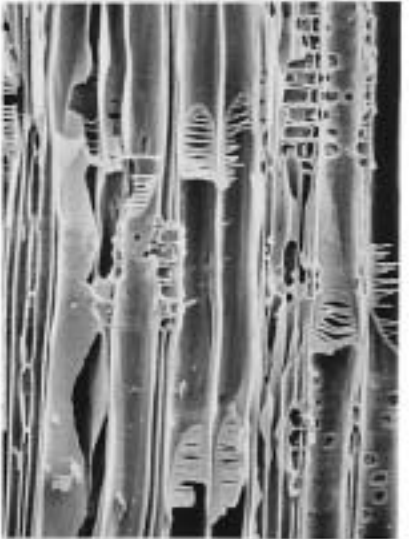
5c ハンノキ属 (放射断面) 11D T125 bar:0.1mm
