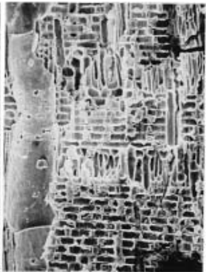
6c アカガシ亜属 (放射断面) 22D T41 bar:0.1mm
