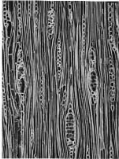
19b トネリコ属 (接線断面) 9D T5 bar:0.1mm
