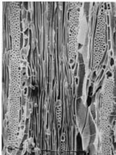
12b ケヤキ (接線断面) 20D T68 bar:0.1mm
