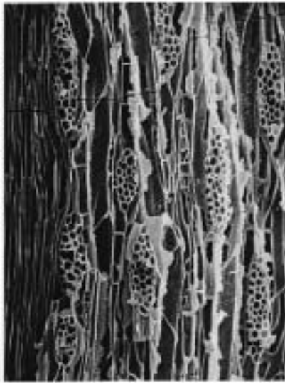
15b キハダ (接線断面) 9D T10 bar:0.1mm
