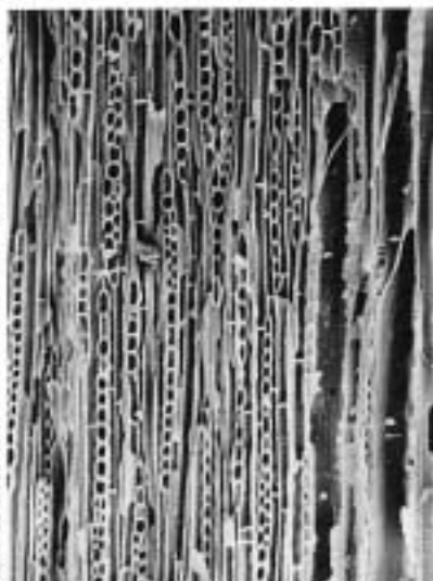
3b イヌシデ節 (接線断面) 9D T37 bar:0.1mm
