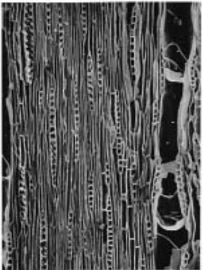
11b クリ (接線断面) 20D T1 bar:0.1mm
