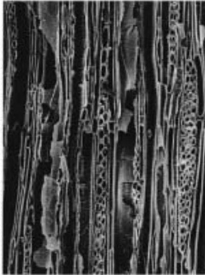
2b 広葉樹A (接線断面) 5D T69 bar:0.1mm
