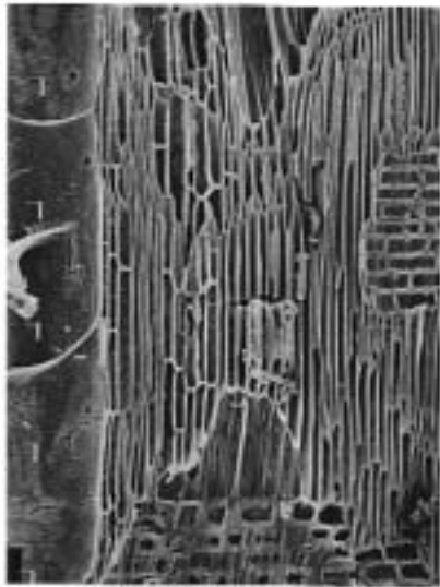
19c トネリコ属 (放射断面) 9D T5 bar:0.1mm
